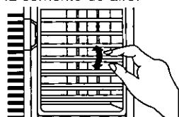
La Paleta de Dirección Vertical de la Corriente de aire se controla colocando la paleta para que descargue el aire hacia arriba, hacia abajo o de frente.
